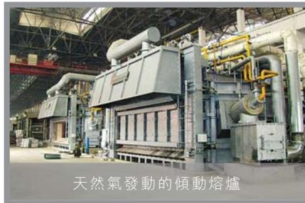
天然氣發動的傾動熔爐
